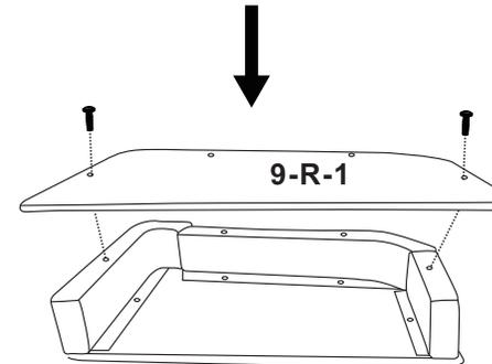
\*HINWEIS: Ziehen Sie die Schrauben NICHT vollständig an, bis alle Schrauben in der richtigen Position befestigt sind.
