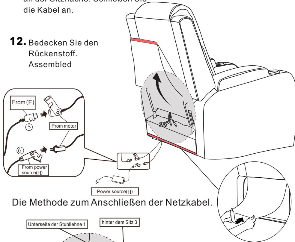
Die Methode zum Anschließen der Netzkabel.
