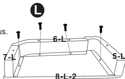
\*HINWEIS: Ziehen Sie die Schrauben NICHT vollständig an, bis alle Schrauben in der richtigen Position befestigt sind.
