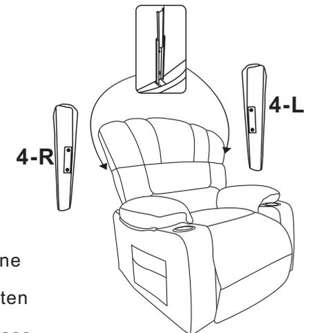
**11.** Entfernen Sie die Unterseite des Rückenstoffs vom Klettverschluss an der Sitzfläche. Schließen Sie die Kabel an.
