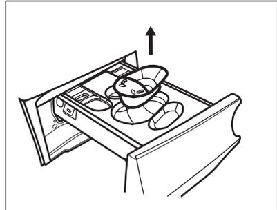
3. Heben Sie die obere Abdeckung der Fächer an, um sie zu entfernen.
