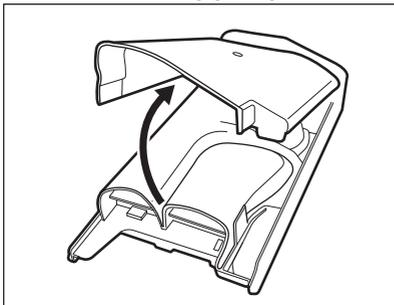
7. Stellen Sie sicher, dass alle Waschmittelrückstände aus dem Einspülkasten entfernt wurden.
