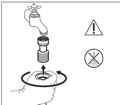
**Zum Schutz des Trinkwassers muss das beiliegende Rückschlagventil zwischen dem Wasserhahn und dem Wasserversorgungsschlauch installiert werden.** Dieses Ventil darf nicht am Gerät montiert werden. Stelle den Schlauch richtig ein. Ziehe die Ringmutter fest, um Leckagen zu vermeiden.
