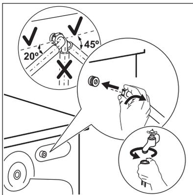
**i** Vergewissere dich, dass sich der Zulaufschlauch nicht in einer vertikalen Position befindet.
