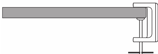
Abbildung 2 Montage der Halterung an der Tisch- bzw. Arbeitsplatte
