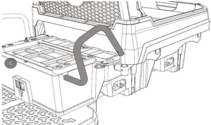
Setzen Sie den Sitz ein und fixieren Sie diesen anschließend mithilfe der 4 Kreuzschrauben.
