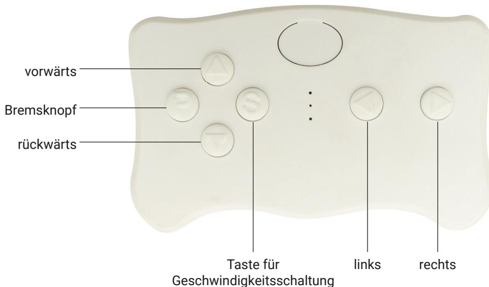
Die Fernsteuerung verfügt über eine Prioritätsfunktion (sog. First-Funktion), d. h. bei Verwendung hat diese Vorrang vor der manuellen Steuerung (Fußschalter).
