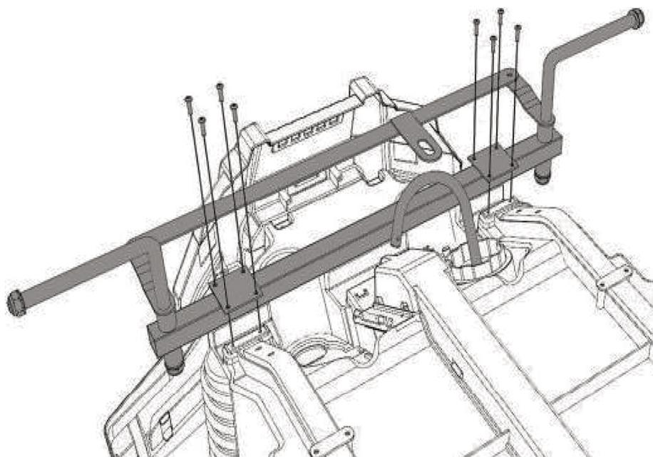
Drehen Sie die Lenkstange nach vorne und führen Sie sie in das Langloch ein. Sichern Sie die Lenkstange mit der Unterlegscheibe und dem Splint.
