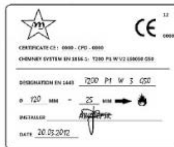
Fig. 4 - Beispiel für Typenschild
