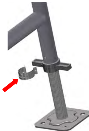
Sichern der Fußplatten
