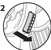
2 Gatillo desbloqueado (la pistola sí pulveriza)
