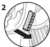
2 Détente débloquée (le pistolet pulvérise)
