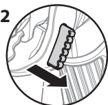
Trekker ontgrendeld (spuiten metpistool mogelijk)
