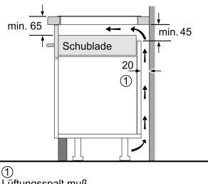
Lüftungsspalt muß vorgesehen werden. min. 550 Maße in mm
