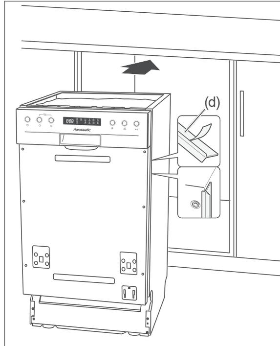
5. Entfernen Sie die Schutzfolien von den seitlichen Abschlussprofilen (d).
