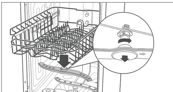
3. Der obere Sprüharm ist mit einem Bajonett-Verschluss befestigt. Zum Abnehmen des Sprüharms halten Sie die beiden gezackten Bajonettgriffe fest und drehen Sie den Sprüharm im Uhrzeigersinn ab.
