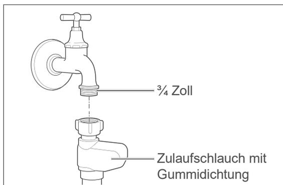
Für die Wasserversorgung benötigen Sie einen Wasserhahn mit einem  $\frac{3}{4}$  Zoll Schraubanschluss.
