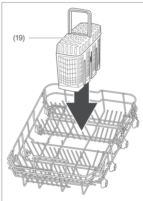
Optimale Spülsergebnisse erreichen Sie, wenn Sie das Besteck mit dem Griff nach unten in den Besteckkorb (19) stecken. Nur scharfe Gegenstände mit den Griffen nach oben in den Besteckkorb stecken.
