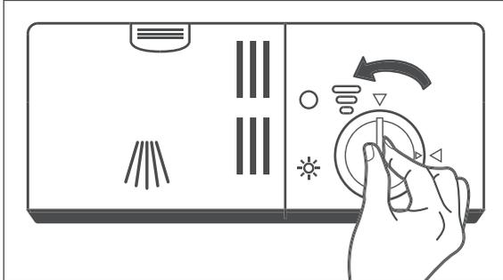
1. Drehen Sie den Verschluss der Klarspülerkammer (22) eine Viertelumdrehung gegen den Uhrzeigersinn und nehmen Sie ihn heraus.
