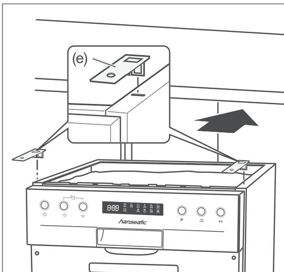
4. Stecken Sie beide Montagewinkel (e) in die vorderen Schlitze an der oberen Seite des Geschirrspülers, um später den Geschirrspüler an die Arbeitsplatte anschrauben zu können.
