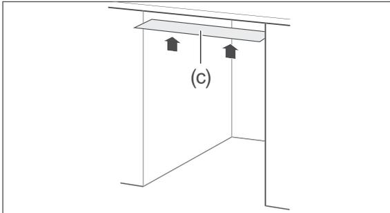
3. Kleben Sie die beiliegende Kondenswasser-Schutzfolie (c) auf die Unterseite der Arbeitsplatte. So vermeiden Sie Schäden an der Arbeitsplatte aufgrund heißer Dämpfe, die bei geöffneter Geschirrspülertür aus dem Geschirrspüler strömen.
