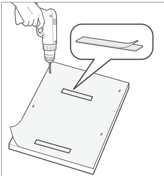
12. Legen Sie die mitgelieferte Bohrschablone so auf die **Rückseite** der Möbelfrontplatte, dass die Bohrschablone und die Möbelfrontplatte oben bündig abschließen.
