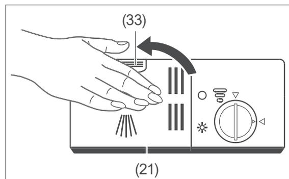
4. Drücken Sie den Deckel der Spülmittelkammer (21) zu, sodass der Verschluss (33) wieder einrastet.
