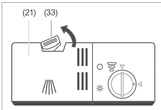
1. Ziehen Sie den Verschluss (33) der Spülmittelkammer (21) nach hinten. Der Deckel springt auf.
