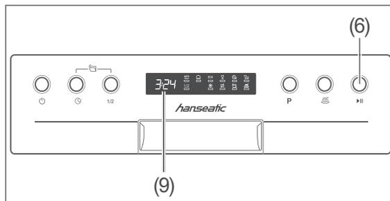
1. Drücken Sie die Taste ▶II (6), um das Spülprogramm zu unterbrechen. Die Restdaueranzeige (9) leuchtet dauerhaft.
