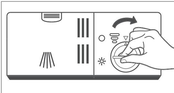
4. Setzen Sie den Verschluss der Klarspülerkammer (22) ein und drehen Sie ihn eine Viertelumdrehung im Uhrzeigersinn fest. Die Markierungen am Deckel und der Klarspülerkammer (22) müssen beim Einsetzen fluchten.
