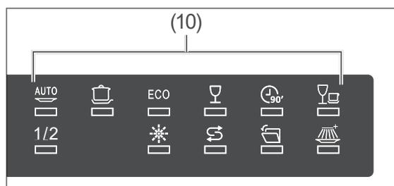
2. Drücken Sie die Taste P (4) so oft, bis das Display das gewünschte Programmsymbol (10) und die Programmdauer (8) anzeigt.
