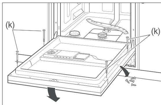
17. Entfernen Sie die 4 Schrauben an der Innenseite der Geschirrspülertür. Schrauben Sie die Möbelfrontplatte an diesen Positionen mithilfe der beiliegenden 4 Schrauben (k) fest. Die Möbelfrontplatte ist damit fertig montiert.
