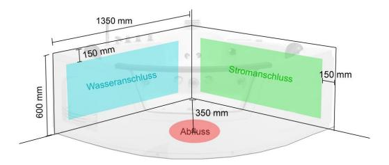
Die Wasser- und Stromanschlüsse sollten rundum ca. 15 cm vom Außenmaß entfernt installiert werden. Der Wasseranschluss sollte einen ½ Zoll betragen und möglichst im 90° Winkel ausgerichtet werden.
