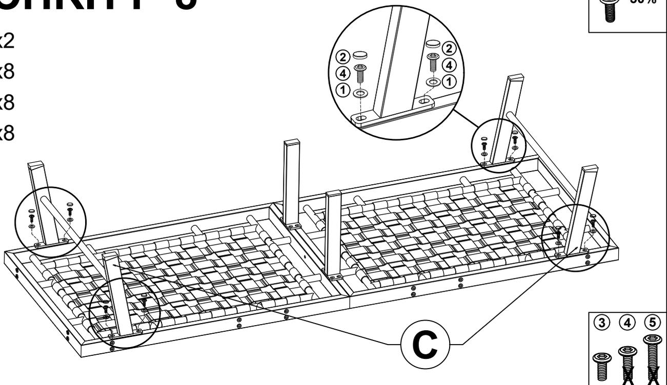
Verbinden Sie das Teil von Schritt 7 und das Seitenbein (C) mit der Schraube (4) und den Unterlegscheiben (1).
