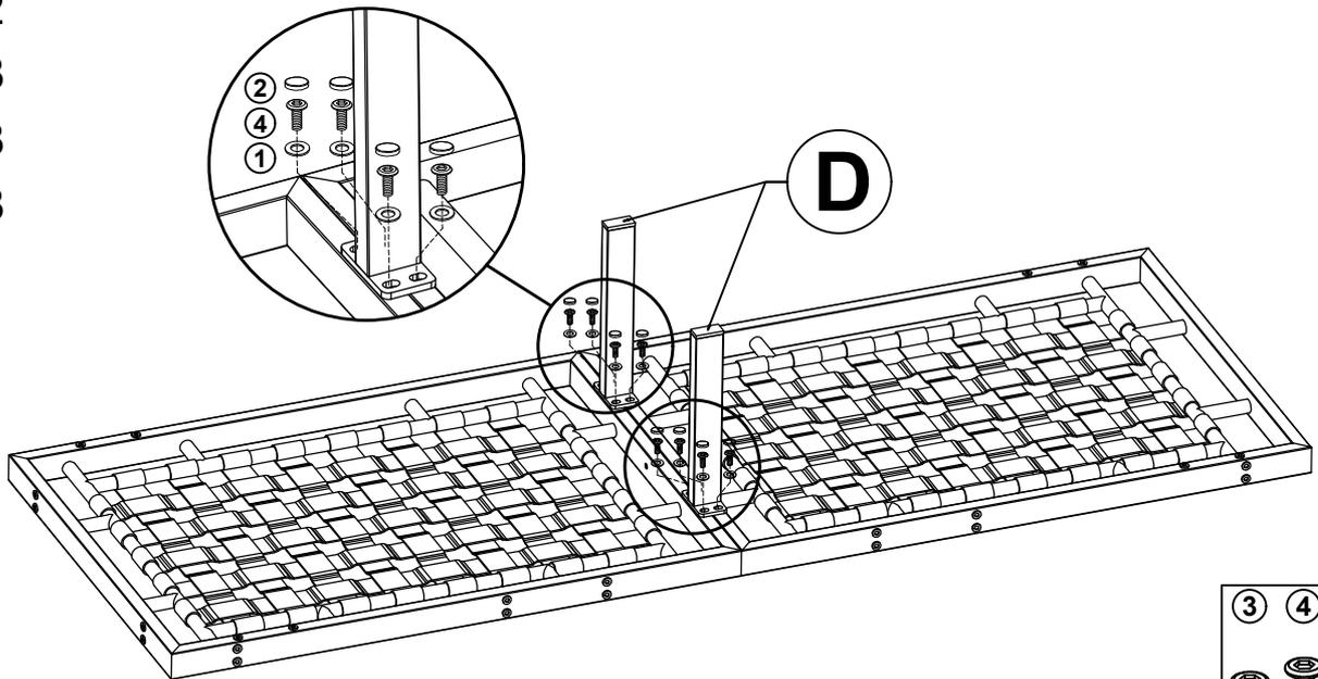
Verbinden Sie das Teil von Schritt 6 und das mittlere Bein (D) mit der Schraube (4) und den Unterlegscheiben (1).
