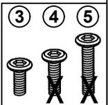
Verbinden Sie das Teil von Schritt 2 und das Seitenbein (C) mit der Schraube (4) und den Unterlegscheiben (1).
