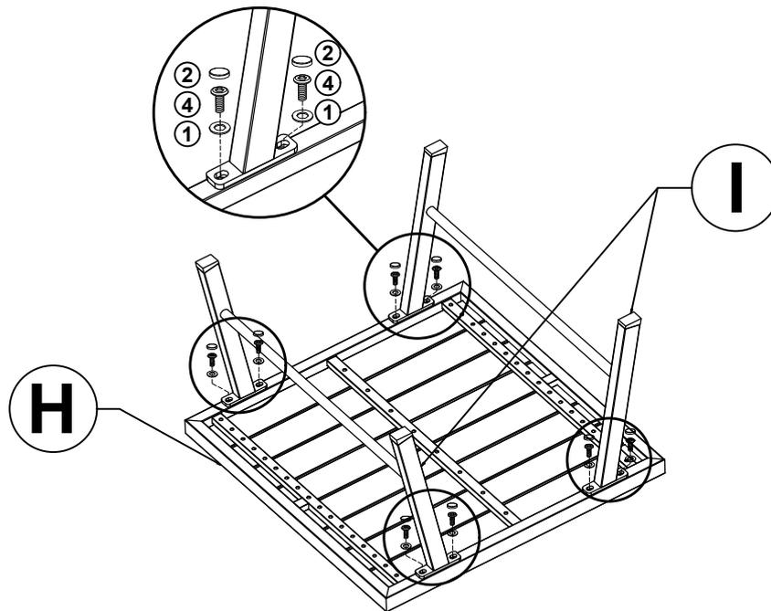
Verbinden Sie Tischplatte (H) und Seitenbein (I) mit der Schraube (4) und den Unterlegscheiben (1).
