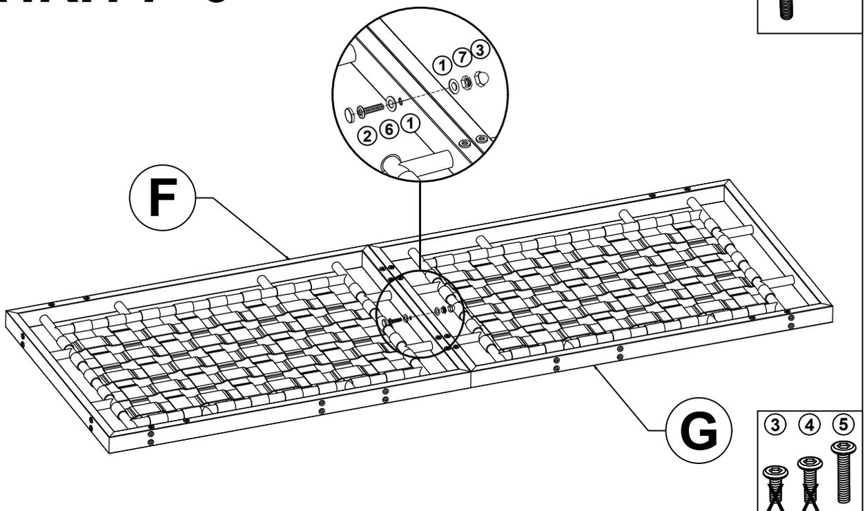
Verbinden Sie die linke Seitenbank (F) und die rechte Seitenbank (G) mit der Schraube (6), Unterlegscheiben (1) und Eru (7) .
