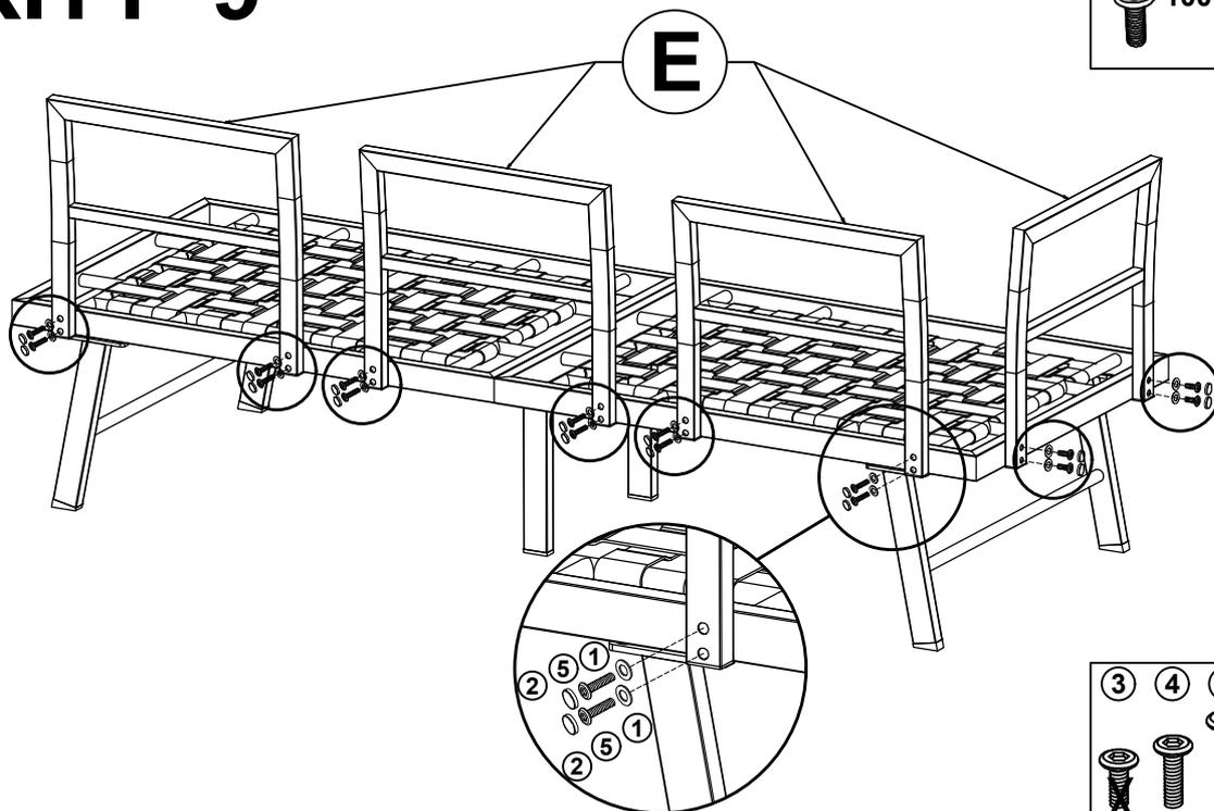
Verbinden Sie das Teil von Schritt 8 und den hinteren Rahmen (E) mit der Schraube (5) und den Unterlegscheiben (1).
