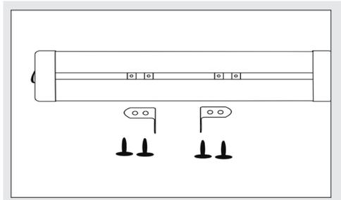
Abb.1b: Befestigungswinkel anbringen
