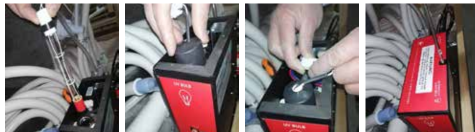
5. Schritt: UV Licht zum Wechseln rausnehmen 6. Schritt: Neues UV Licht in die Metallröhre stecken und schwarze Abdeckung wieder platzieren 7. Schritt: Weiße Verbindungsstücke wieder verkuppeln 8. Schritt: Rote Abdeckung wieder festschrauben
