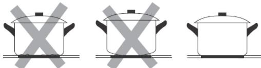
Les ustensiles de cuisine fabriqués à partir des matériaux suivants ne sont pas compatibles : acier inoxydable pur, aluminium ou cuivre sans fond magnétique, verre, bois, porcelaine, céramique et faïence. N'utilisez pas d'ustensiles de cuisine ayant des bords tranchants ou un fond arrondi.
