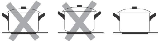
La batería de cocina que esté fabricada en los siguientes materiales no podrá utilizarse: acero inoxidable puro, aluminio o cobre sin fondo magnético, cristal, madera, porcelana, cerámica o latón. No utilice ningún recipiente con cantos afilados ni que presente un fondo abombado.
