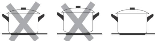
Le pentole realizzate con i seguenti materiali non sono adatte: acciaio inossidabile puro, alluminio o rame senza fondo magnetico, vetro, legno, porcellana, ceramica e terracotta. Non utilizzare pentole con bordi affilati o con la parte inferiore arrotondata.
