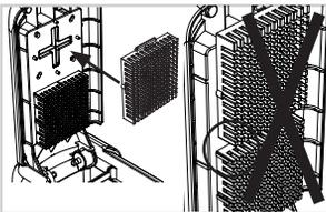
Setzen Sie das lose Stifteraster in das Schneid-Oberteil ein. Zwischen den beiden Stifterastern existiert kein Spalt, sondern es entsteht eine durchgängige Fläche - analog zu dem XXL-Messereinsatz. Achten Sie darauf, das Stifteraster nicht verkehrt herum einzusetzen. Setzen Sie das Reinigungsgitter auf das lose Stifteraster.
