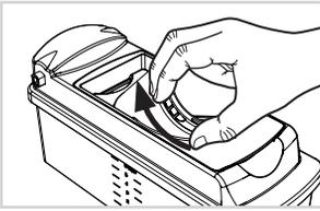
Den gewünschten Spiraleinsatz in den Rahmen einsetzen und im Uhrzeigersinn drehen, bis er einrastet. Achten Sie darauf, dass die Klinge nach dem Einsetzen nach unten Richtung Auffangbehälter zeigt (beachten Sie dazu auch die Markierungen auf Rahmen und Spiraleinsatz).
