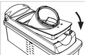
Das Schneid-Unterteil auf den Auffangbehälter setzen und hörbar einrasten. Danach den Rahmen in das Schneid-Unterteil einsetzen und einrasten.
