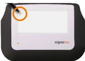
Nach dem Bootvorgang leuchtet die LED orange. Im linken oberen Bereich des Displays werden zwei sich kreuzende schmale Linien auf einem weißen Hintergrund angezeigt.
