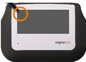
Trennen Sie die Verbindung zwischen dem Pad und der Stromversorgung. Berühren Sie mit dem Stift die **linke obere Ecke** des Displays. Während Sie den Stift halten, schließen Sie das Pad wieder an die Stromversorgung an.
