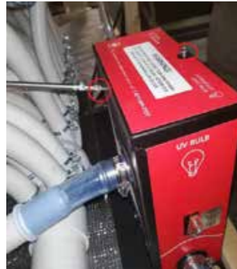
1. Schritt: Lösen Sie die 2 rot markierten Schrauben.
