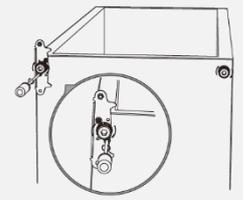
14. Stift des oberen Scharniers in die obere Vorrichtung der Gerätetür einsetzen.
