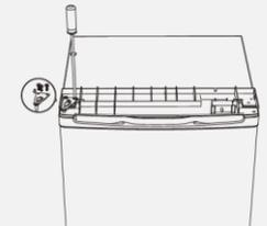
18. Abdeckplatte auflegen und hinten mit den beiden Schrauben befestigen.
