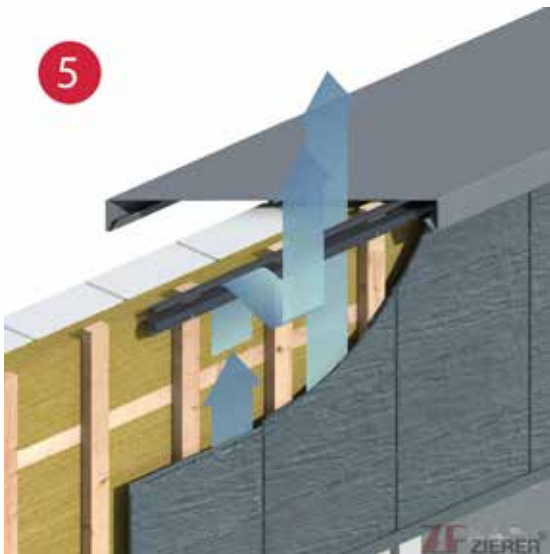
Oberer Abschluss zum Dachanschluss, Dachschräge (Entlüftung).
