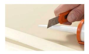
• Kleberkartusche einspannen, Kartuschendüse abschneiden (Durchmesser 5-8 mm).
