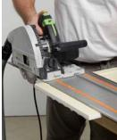
Paneele zuschneiden (Handsäge entlang eines Vierkantholzes oder Handkreissäge mit Schiene).
