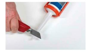
• Kleberkartusche einspannen, Kartuschendüse abschneiden (Durchmesser 5-8mm).
