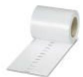
Marker für Klemmen, Rolle, weiß, unbeschriftet, beschriftbar mit: THERMOMARK ROLL 2.0, THERMOMARK ROLL, THERMOMARK ROLL X1, THERMOMARK ROLLMASTER 300/600, THERMOMARK X1.2, THERMOMARK S1.1, perforiert, Montageart: verrasten in Universalschildchennut, verrasten in flacher Schildchennut, für Klemmenbreite: 10,2 mm, Schriftfeldgröße: 6,35 x 10,15 mm, Anzahl der Einzelschilder: 10000
