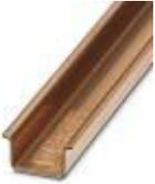
Tragschiene ungelocht, Standardprofil, Breite: 35 mm, Höhe: 15 mm, ähnlich EN 60715, Material: Kupfer, unbeschichtet, Länge: 2000 mm, Farbe: kupferfarben
