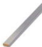
N-Sammelschiene, Breite: 10 mm, Höhe: 3 mm, DIN VDE 0611-4: 1991-02, Material: Kupfer, verzinkt, Länge: 1000 mm, Farbe: silberfarben
