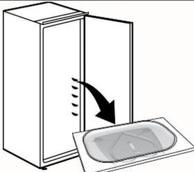
**Einlegeboden entfernen:** Den Einlegeboden vorsichtig aus dem Kühlschrank herausziehen, um an den Frostswing zu gelangen.
