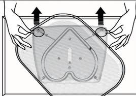
**Drehteller entfernen:** Fassen Sie den Frostswing an den Rändern und heben Sie ihn leicht an, um die Saugnäpfe zu lösen. Wenn nötig, einen flachen Gegenstand wie eine Kreditkarte verwenden, um die Saugnäpfe vorsichtig vom Regal zu trennen.
