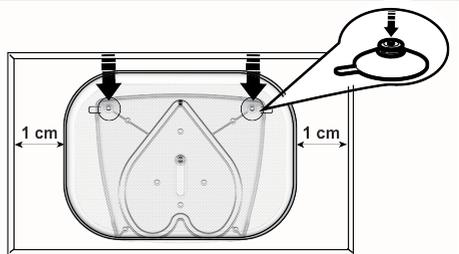
**Positionierung des Frostswing:** Platzieren Sie den Frostswing in der Mitte der Ablage, indem Sie die Saugnäpfe fest andrücken. Achten Sie darauf, dass die Saugnäpfe zur Innenseite des Kühlschranks zeigen.
