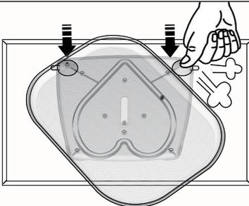
**Luft entfernen:** Drücken Sie fest auf die Mitte des Frostswing, um sicherzustellen, dass alle Luft unter den Saugnäpfen entwichen ist und die Saugnäpfe fest sitzen.
