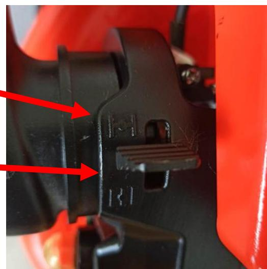
Palanca de arranque / Choke abierto
