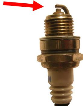
L'écartement des électrodes doit être compris entre 0,6 et 0,7 mm.
