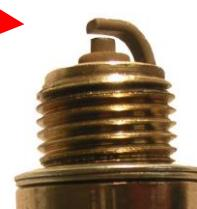
La distancia entre los electrodos debe ser de entre 0,6 y 0,7 mm.
