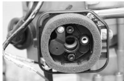
1. abrir a alavanca de arranque
