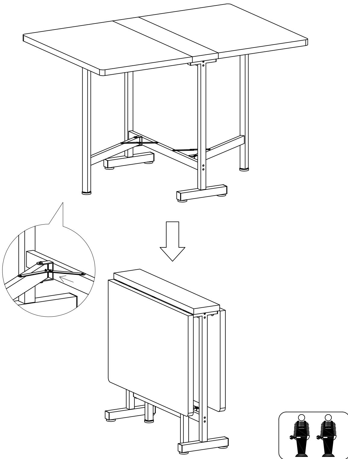
Vor dem Einbau die Schrauben in die Löcher stecken und festziehen, aber nicht bis 100%, 70% bis 80% anziehen reicht aus. Schließlich, nachdem alle Schrauben installiert sind, ziehen Sie alle Schrauben auf 100%. Wenn Sie auf diese Probleme stoßen, z.B. wenn die Löcher nicht ausgerichtet werden können oder einige Teile nicht installiert werden können, überprüfen Sie bitte, ob die Schrauben korrekt verwendet werden und passen Sie die Dichtheit der Schrauben an.
