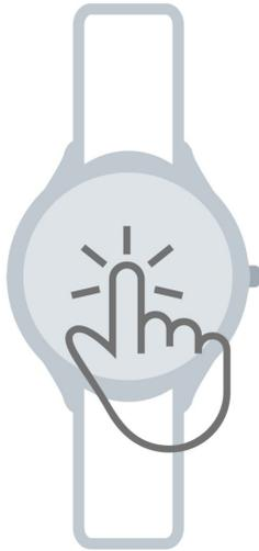
Die Bildschirmsteuerung funktioniert durch Berühren des Bildschirms mit der Fingerspitze und mit der rechten Taste. Wischen Sie mit der Fingerspitze nach links oder rechts um zu den verschiedenen Menüoptionen der Uhr zu gelangen. Drücken Sie die rechte Taste der Uhr um zu dem Uhrenbildschirm zurück zu gelangen.
