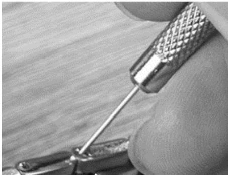
Um Ihr Armband auf die gewünschte Länge zu kürzen, müssen Sie nicht benötigte Verbindungsstücke entfernen. Dazu müssen Sie die Stifte entfernen, die die Verbindungsstücke zusammenhalten. Sie erkennen dies an den kleinen Löchern an der Seite. Positionieren Sie die Nadel so, dass Sie auf ein Loch trifft. Nun können Sie den Stift herausdrücken.
