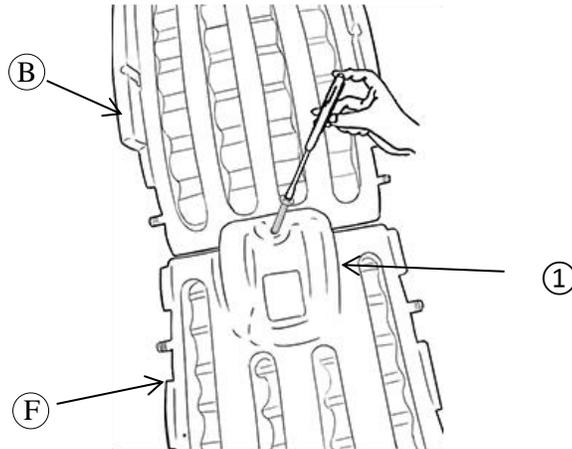
Verwenden Sie 14 \* Teil 5 (Plastische Mutter), um Teil C (2 \* Lange Armlehne und 2 \* Kurze Armlehne) und die Hauptplatte (Teil B und Teil F) auf beiden Seiten zu verbinden, und befestigen Sie sie dann mit 2 \* Teil 4 (Eisenschraube).
