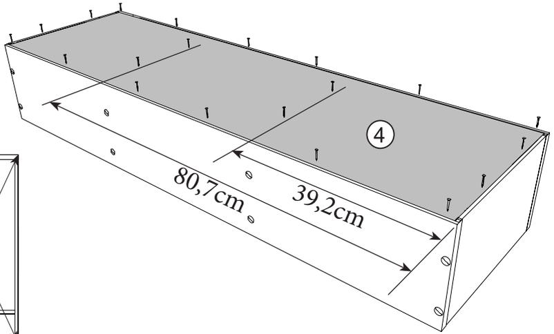
**FR-** Mesurer les diagonales du meuble pour vérifier l'équerrage. La mesure doit être identique.
