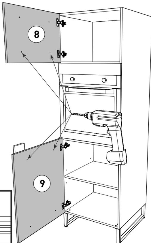
Utiliser une cale pour percer les trous de poignée
