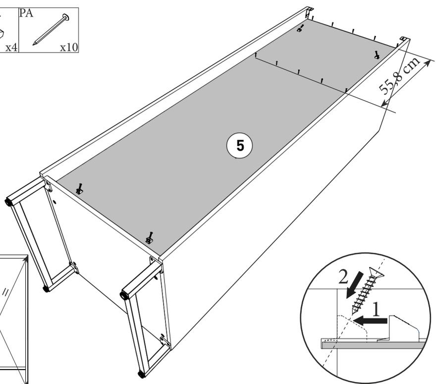
FR- Mesurer les diagonales du meuble pour vérifier l'équerrage. La mesure doit être identique.
