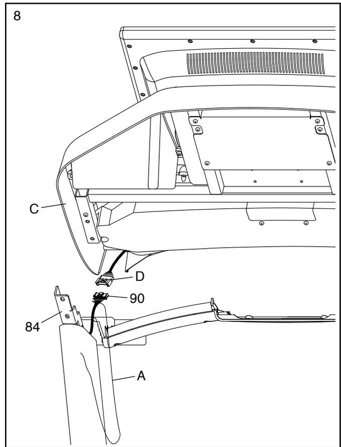
9. Befestigen Sie die Computereinheit (C) mit den vier 1/4" x 1/2" Schrauben (20), die Sie in Schritt 6 entfernt haben, und vier 1/4" Zahnscheiben (11) an den Haltestangen (83, 84). **Drehen Sie anfangs alle vier Schrauben lose ein, dann ziehen Sie diese fest. Achten Sie darauf, die Kabel (E) nicht einzuklemmen.**
