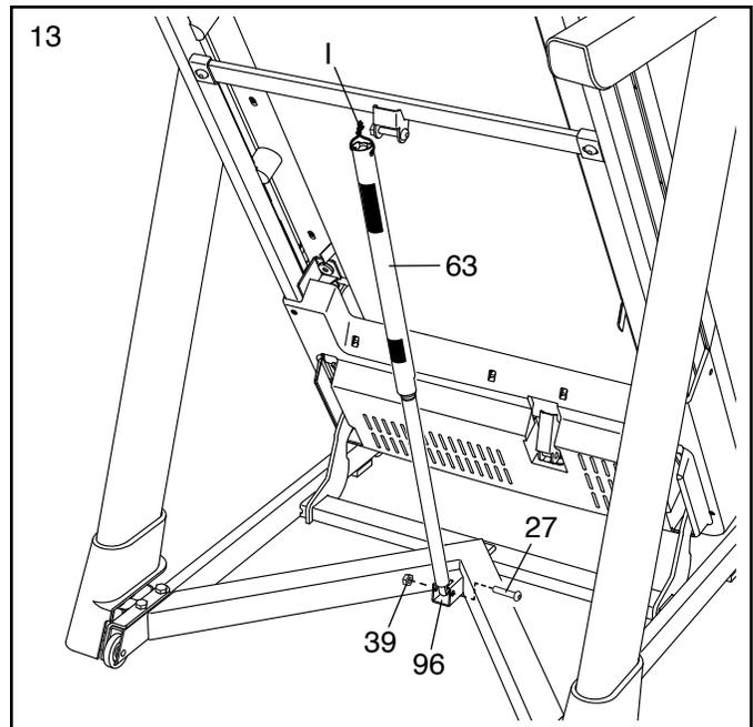
14. Entfernen Sie die 5/16" Mutter (39) und den 5/16" x 2 1/4" Bolzen (28) von der Halterung der Arretierungsquerstange (59).
