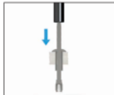
Test Nietdornausdrückkraft Mandrel push out test Essai de retenue de la tête de rivet
