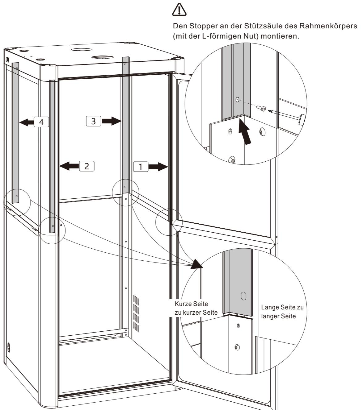
15 Glasstützleiste installieren
