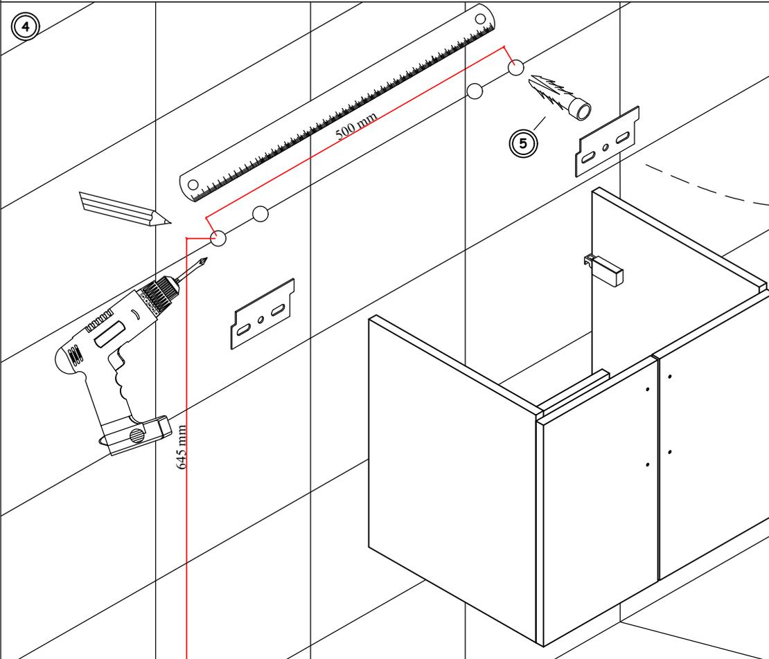
BOHREN SIE MIT EINEM SCHLAGBOHRER LÖCHER ENTSPRECHEND DER ANGEZEIGTEN ABSTÄNDE ZUR ANBRINGUNG DER AUFHÄNGUNGSELEMENTE. STECKEN SIE ANSCHLIEßEND DIE DÜBEL IN DIE LÖCHER. VERSCHRAUBEN SIE DIE AUFHÄNGUNGSELEMENTE IN DIE ANGEBRACHTEN DÜBEL.
