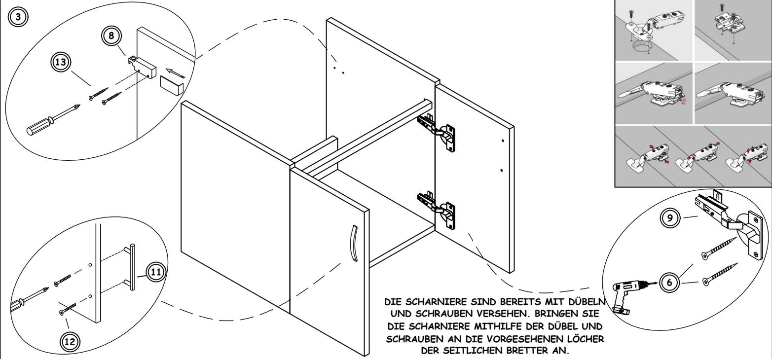
DIE SCHARNIERE SIND BEREITS MIT DÜBELN UND SCHRAUBEN VERSEHEN. BRINGEN SIE DIE SCHARNIERE MIT HILFE DER DÜBEL UND SCHRAUBEN AN DIE VORGEGEHENEN LÖCHER DER SEITLICHEN BRETTER AN.
