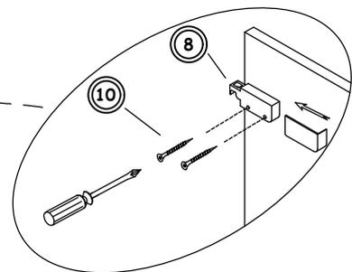
MONTIEREN SIE DAS AUFHÄNGUNGSELEMENT AN DEN SCHRANK.
