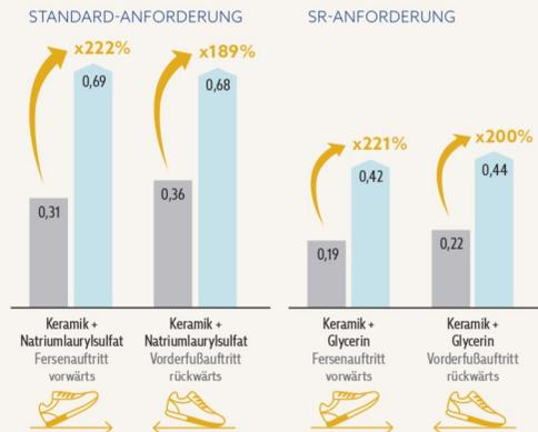
Rutschfestigkeitsprüfung nach EN ISO 20344:2021, durchgeführt von Intertek Testing Services Shenzhen Ltd., im August 2022; auf einer Skala von 0,0 (ohne Rutschhemmung) bis 1,0 (sehr hohe Rutschfestigkeit, z. B. auf trockenen Teppichböden). Alle SFC Schuhe sind ausgestattet mit der patentierten, rutschhemmenden Shoes For Crews Außensohle.
