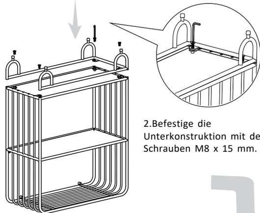
2. Befestige die Unterkonstruktion mit den Schrauben M8 x 15 mm.
