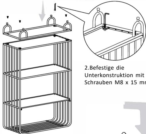
2. Befestige die Unterkonstruktion mit den Schrauben M8 x 15 mm.
