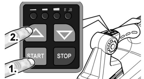
**HINWEIS:** Beim Betrieb mit höchster Blasgeschwindigkeit (rote LED leuchtet) schaltet das Gerät automatisch nach 30 Sekunden eine Stufe herunter, um die Akku-Kapazität zu verlängern.
