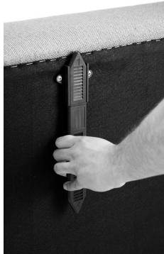
Het model aan de te koppelen zijde optillen en op diens zijde leggen. De koppelverbinding beetpakken en krachtig parallel uit de houder trekken. Hierbij niet naar boven verdraaien omdat hierdoor de houder kan breken!
