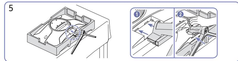
Halten Sie das Gerät an der Rückseite fest (siehe Abbildung). Schieben Sie den montierten Standfuß in Pfeilrichtung (siehe Abbildung) in das Gerätegehäuse hinein.
