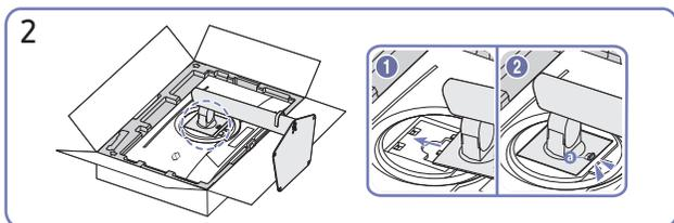
Schieben Sie den montierten Standfuß in Pfeilrichtung (siehe Abbildung) in das Gerätegehäuse hinein.
