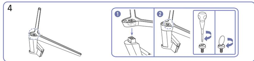
Stellen Sie den Standfuß in der in der Abbildung gezeigten Richtung auf den Standfußanschluss. Vergewissern Sie sich, dass der Standfußanschluss fest verbunden ist.
