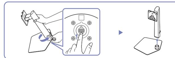
Heben Sie den montierten Ständer leicht an und drücken Sie die PUSH-Taste auf der Fußunterseite.
