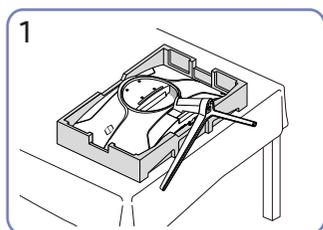
Legen Sie den Styroporrahmen aus der Packung auf den Boden und legen Sie das Gerät mit der Vorderseite nach unten wie abgebildet auf den Styroporrahmen. Wenn kein Styropor verfügbar ist, verwenden Sie eine dicke Sitzmatte.
