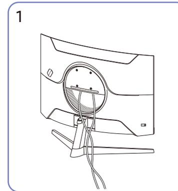
Schließen Sie die entsprechenden Kabel an.
