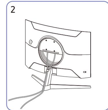
Verlegen Sie beide Kabel wie in der Abbildung gezeigt im Kabelhalter am Standfuß (STANDFUSSKABEL-HALTERUNG), um die Kabel zu organisieren. Die Montage ist abgeschlossen.
