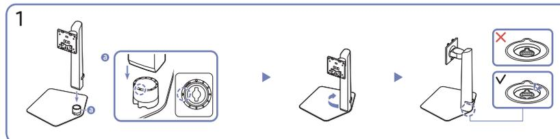
Überprüfen Sie die Richtung des Pfeils auf dem Standfuß. Richten Sie die Richtung des Pfeils auf dem Standfuß an der Vorderrichtung des Standfußanschlusses aus und setzen Sie den Standfußanschluss von oben nach unten ein.
