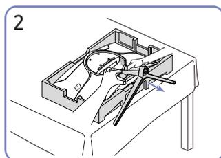
Halten Sie das Gerät mit einer Hand fest und ziehen Sie mit der anderen Hand den Standfußanschluss heraus (siehe Abbildung).
