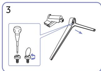
Nehmen Sie den Standfußanschluss aus dem Standfuß. Ziehen Sie ihn dazu in Pfeilrichtung (siehe Abbildung).
