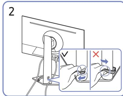
Ziehen Sie an der rechten Seite der STANDFUSSKABEL-HALTERUNG zum Entfernen von dem Standfuß. Die linke Seite des HALTERUNGSSTÄNDERKABELS kann beschädigt werden, wenn mit Gewalt daran gezogen wird.
