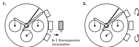
• Ziehen Sie die Krone in die I. Einrastposition heraus sobald sich der Sekundenzeiger in der 12-Uhr-Stellung befindet.
