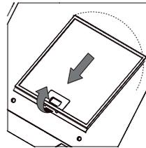
❸ Stecken Sie den Kohlefilter auf das Gerät und drehen Sie ihn im Uhrzeigersinn.
