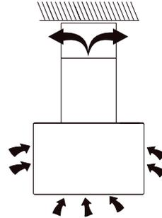
❷ Sie können nur beim Umluftbetrieb Kohlefilter zur Geruchsbindung verwenden. Entnehmen Sie zur Installation der Kohlefilter zuerst den Fettfilter. Drücken Sie hierzu auf den Verschluss und ziehen Sie dann den Fettfilter nach unten.
