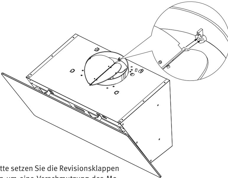
Bitte setzen Sie die Revisionsklappen ein um eine Verschmutzung des Motors von außen zu verhindern.
