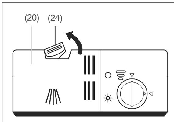
1. Ziehen Sie den Verschluss (24) der Spülmittelkammer (20) nach hinten. Der Deckel springt auf.
