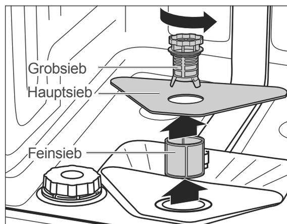
Überprüfen Sie nach jedem Spülgang das Grobsieb, das Hauptsieb und das Feinsieb und entfernen Sie ggf. Speisereste und Fremdkörper:
