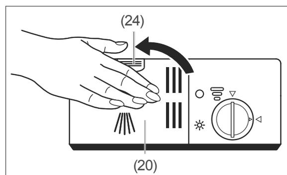
4. Drücken Sie den Deckel der Spülmittelkammer (19) zu, sodass der Verschluss (24) wieder einrastet.
