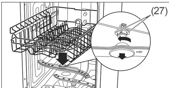
3. Der obere Sprüharm ist mit einem Bajonett-Verschluss befestigt. Zum Abnehmen des Sprüharms halten Sie die beiden gezackten Bajonettgriffe (27) fest und drehen Sie den Sprüharm im Uhrzeigersinn ab.
