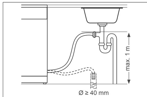
Sie können den Auslass des Ablaufschlauchs auf zwei verschiedene Weisen anschließen lassen:
