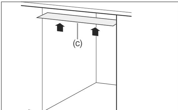
3. Kleben Sie die beiliegenden Schutzfolie für Kondenswasser (c) auf die Unterseite der Arbeitsplatte. So vermeiden Sie Schäden an der Arbeitsplatte aufgrund heißer Dämpfe, die bei geöffneter Tür aus dem Geschirrspüler strömen.
