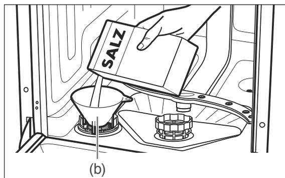
3. Setzen Sie den mitgelieferten Einfülltrichter (b) auf die Kammeröffnung.
