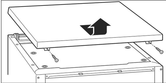
2. Lösen Sie die beiden Schrauben auf der Rückseite der Abdeckplatte und nehmen Sie diese ab.
