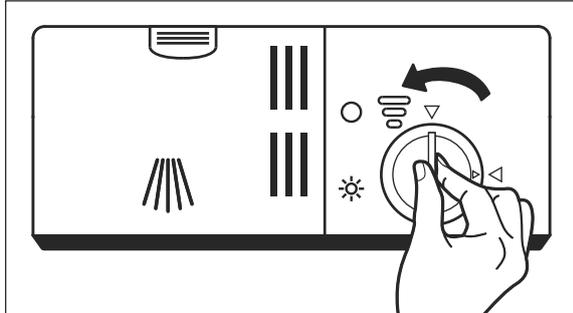
1. Drehen Sie den Verschluss der Klarspülerkammer (19) eine Viertelumdrehung gegen den Uhrzeigersinn und nehmen Sie ihn heraus.
