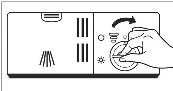
4. Setzen Sie den Verschluss der Klarspülerkammer (19) ein und drehen Sie ihn eine Viertelumdrehung im Uhrzeigersinn fest. Die Markierungen am Deckel und der Klarspülerkammer (19) müssen beim Einsetzen fluchten.
