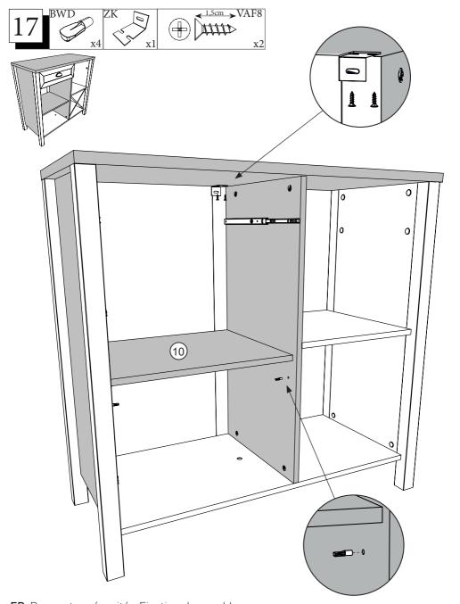
**FR**-Pour votre sécurité : Fixation du meuble au mur. Attention, la fixation doit être réalisée par une personne compétente car cela nécessite des chevilles adaptées à la nature de votre mur.
