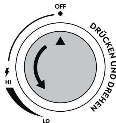
**WARNUNG:** Zündet der Brenner auch nach mehrfachen Versuchen nicht, drehe den Stellknopf im Uhrzeigersinn in die „OFF“-Position und drehe das Ventil der Gasflasche zu. Warte 5 Minuten und beginne erneut bei Schritt 4.
