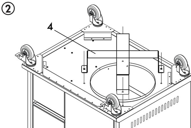
**HINWEIS:** Schraube die Gasflaschenhalterung per Hand fest und drehe dann den Unterbau mit 2 Personen um. Ziehe die Schrauben der Gasflaschenhalterung mit einem Schraubenzieher nach.
