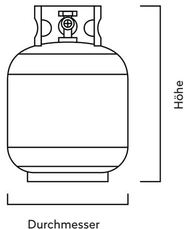
Verwende Composite-Kunststoff-Gasflaschen nicht im Grill, da sie zu hoch sind. Führe den Gasschlauch durch die Aussparung in der Seitenwand nach außen. Verbinde die Gasflasche außerhalb des Grills mit dem Gasschlauch.
