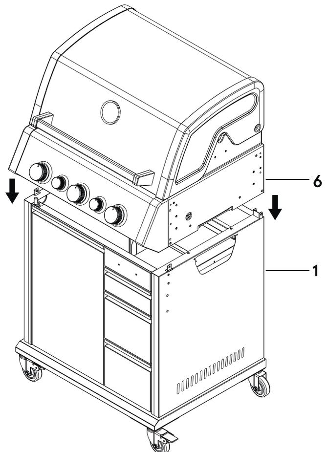
**ACHTUNG:** Du findest alle Gas- und Stromleitungen im Frontpanel verstaut. Entferne die Transportsicherung und führe die Enden aller Kabel und Gasleitungen vorsichtig heraus. Die Enden müssen beim Aufsetzen in den Innenraum fallen. Achte darauf, dass sie nicht eingeklemmt sind.
