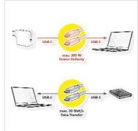
Zu den wichtigsten Vorteilen von USB4 gehören die schnellere Übertragungsgeschwindigkeit (bis zu 40 Gbit/s bis max. 1 m bzw. bis zu 20 Gbit/s bei 2 m), eine bessere Verwaltung der Videobandbreite (durch ein Verfahren namens "Protokoll-Tunneling", das DisplayPort-, PCIe- und USB-Pakete gleichzeitig sendet und die Bandbreite entsprechend zuweist) und eine optionale Kompatibilität mit Thunderbolt-3-Produkten.
