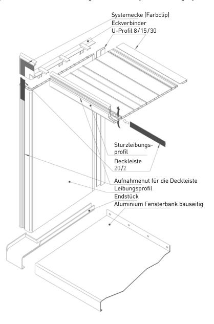
Für die Entlüftung der Fassadenfläche unter der Fensterbank muss zwischen der Oberkante des vinyTop Profils und der Unterkante der Fensterbank ein Spalt von mindestens 5 mm belassen werden. Um Verschmutzungen der Fassadenoberfläche zu vermeiden, empfehlen wir einen Fensterbanküberstand von 3 – 4 cm und den Einbau von Fensterbankendstücken (Art.-Nr.: 0 63 60 \_\_\_).
