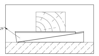
Unebenheiten einer Hauswand können mit Montagekeilen ausgeglichen werden. Verdrehungen der Latten sind dabei zu vermeiden. Wenn Fassadenprofile auf verdrehte oder unebene Unterkonstruktionen montiert werden, können Verwölbungen entstehen.
