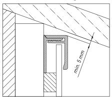
Auch die Zubehörprofile unterliegen bei Temperaturerhöhungen einer Wärmeausdehnung. Es ist unbedingt darauf zu achten, dass an den Profilenden zu anderen feststehenden Bauteilen genügend Raum für die Ausdehnung vorhanden ist. Die Oberteile von senkrecht montierten 2-teiligen Zubehörprofilen sind gegen Abrutschen im oberen Bereich, z. B. mit Montagekleber, Silikon oder Schrauben, zu fixieren.
