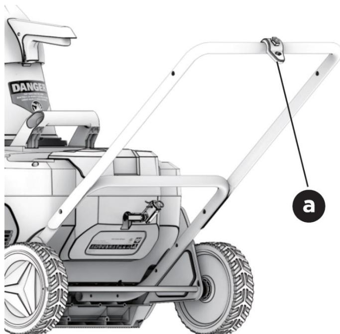
Stecken Sie den Hebel für die Holmfixierung mit Unterlegscheibe von der Außenseite des mittleren Holm durch die ausgerichteten Löcher. Befestigen Sie das Verbindungsstück am Ende des Verriegelungshebels von der Innenseite des unteren Holms aus und drehen sie den Hebel im Uhrzeigersinn um ihn später spannen zu können (siehe folgende Abbildungen).
