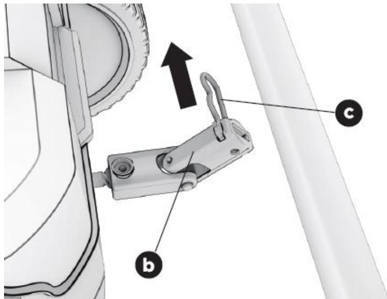
Schuif de draaihendel van de uitwerpopening door de beugel op de middelste handgreep. Zorg ervoor dat de kruk van de draaihendel naar beneden wijst. Steek vervolgens de hendel in de opening aan de achterkant van de behuizing.
