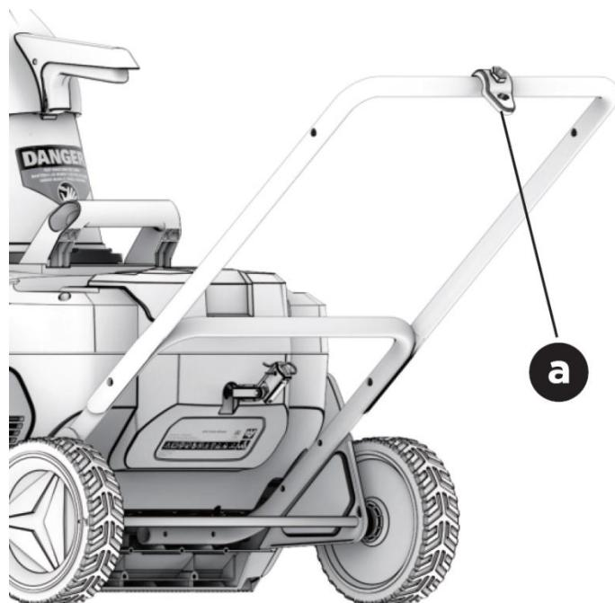
Włóż dźwignię mocującą kierownicę z podkładką od zewnętrznej strony środkowej kierownicy przez dopasowane otwory. Zamocuj łącznik na końcu dźwigni blokującej od wewnętrznej strony dolnego drążka i obróć dźwignię w kierunku zgodnym z ruchem wskazówek zegara, aby ją później dokręcić (patrz poniższe ilustracje).
