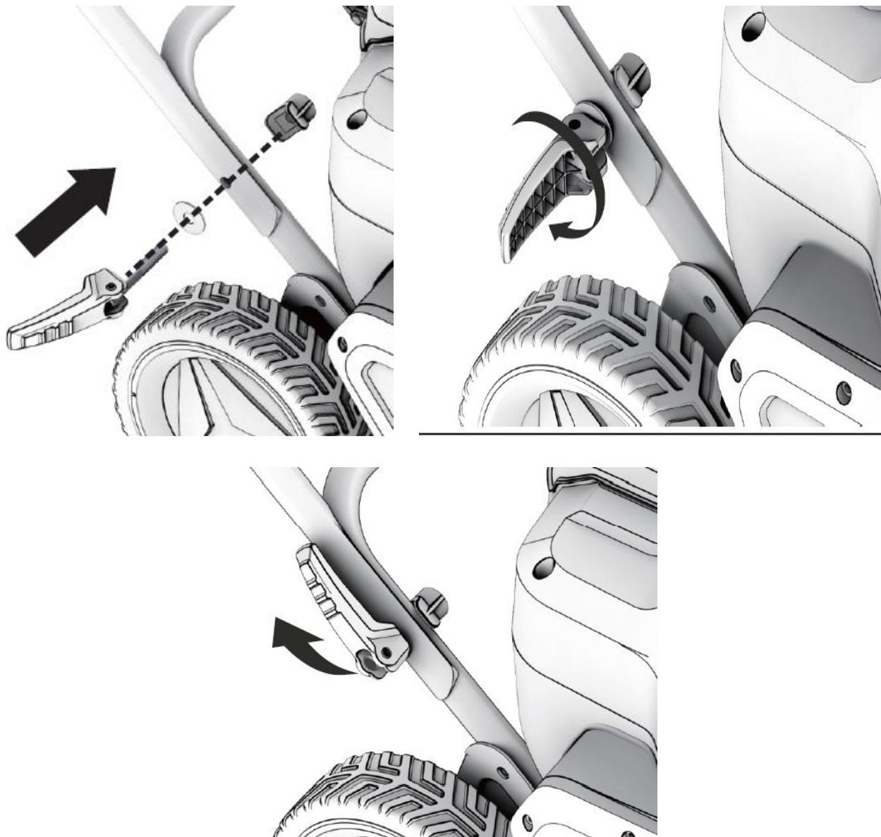
Seguire gli stessi passaggi quando si assembla la barra superiore con la barra centrale (vedere le illustrazioni seguenti)
