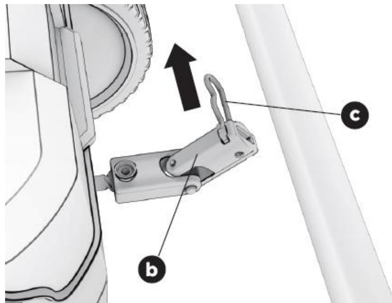
Skjut den roterande spaken genom konsolen på mitthandtaget. Se till att vridspakens vev pekar nedåt. Sätt sedan in spaken i öppningen på baksidan av fodralet.
