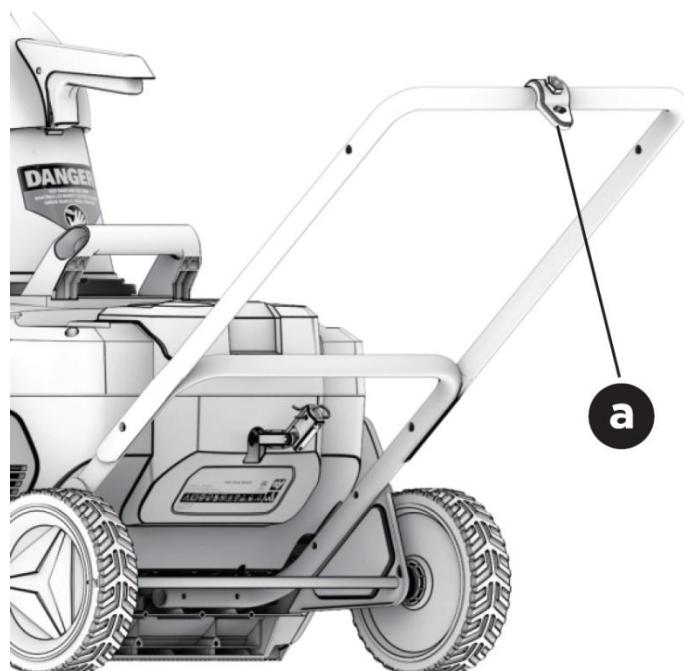
Steek de stuurbevestigingshendel met sluitring vanaf de buitenkant van het middelste stuur door de uitgelijnde gaten. Bevestig de connector aan het uiteinde van de vergrendelhendel vanaf de binnenkant van de onderste stang en draai de hendel rechtsom om hem later vast te zetten (zie de volgende afbeeldingen).
