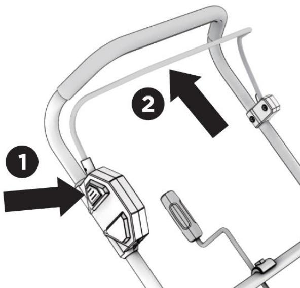
Il dispositivo ora si avvia. Se si rilascia la maniglia dell'acceleratore, il dispositivo smette di funzionare.
