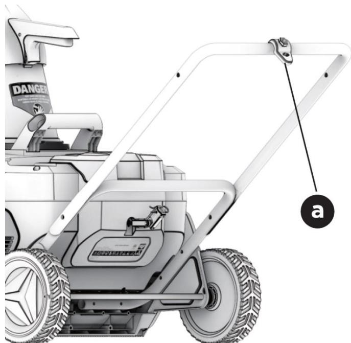
Insira a alavanca de fixação do guidão com arruela pela parte externa do guidão central através dos furos alinhados. Prenda o conector na extremidade da alavanca de travamento na parte interna da barra inferior e gire a alavanca no sentido horário para apertá-la mais tarde (veja as ilustrações a seguir).
