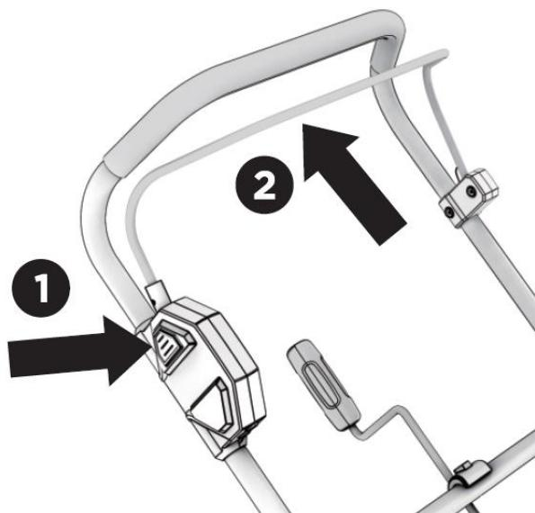
El dispositivo ahora se inicia. Si suelta el mango del acelerador, el dispositivo deja de funcionar.
