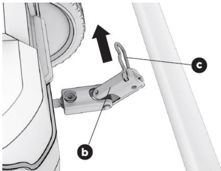
Far scorrere la leva di rotazione dello scivolo attraverso la staffa sulla maniglia centrale. Assicurarsi che la manovella della leva rotante sia rivolta verso il basso. Quindi inserire la leva nell'apertura sul retro della custodia.
