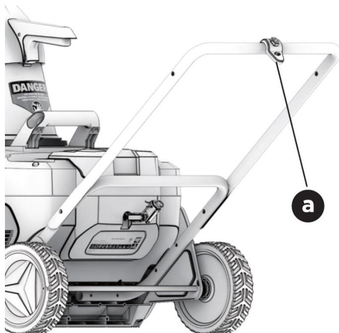
Insérez le levier de fixation du guidon avec la rondelle depuis l'extérieur du guidon central à travers les trous alignés. Fixez le connecteur à l'extrémité du levier de verrouillage depuis l'intérieur de la barre inférieure et tournez le levier dans le sens des aiguilles d'une montre pour le serrer ultérieurement (voir les illustrations suivantes).
