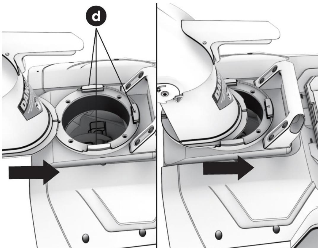
Utilizzare un cacciavite (non incluso) per fissare lo scivolo di espulsione con la vite inclusa come mostrato di seguito.
