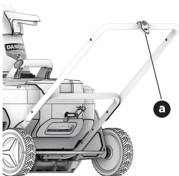
Inserte la palanca de fijación del manillar con arandela desde el exterior del manillar central a través de los orificios alineados. Conecte el conector al extremo de la palanca de bloqueo desde el interior de la barra inferior y gire la palanca en el sentido de las agujas del reloj para apretarla más tarde (consulte las siguientes ilustraciones).
