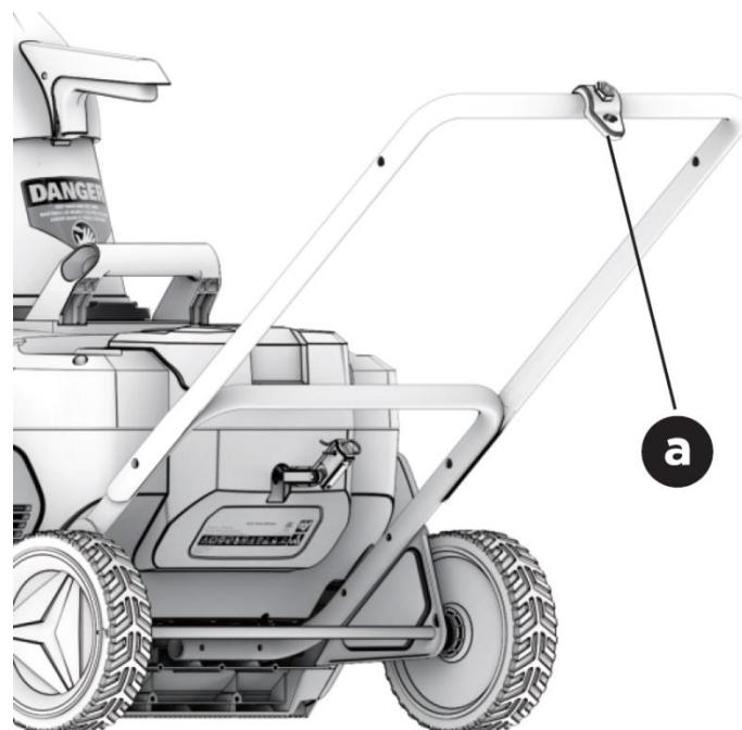
För in styrets fixeringsspak med bricka från utsidan av mittstyret genom de inriktade hålen. Fäst kontakten i änden av låsspaken från insidan av den nedre stången och vrid spaken medurs för att dra åt den senare (se följande illustrationer).
