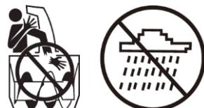
Nunca coloque a mão na rampa de ejeção quando o motor estiver funcionando! Existe um risco significativo de ferimentos! Não exponha o soprador de neve à chuva!
