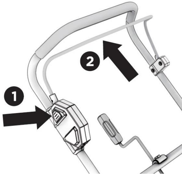
O dispositivo agora é iniciado. Se você soltar a alavanca do acelerador, o dispositivo para de funcionar.
