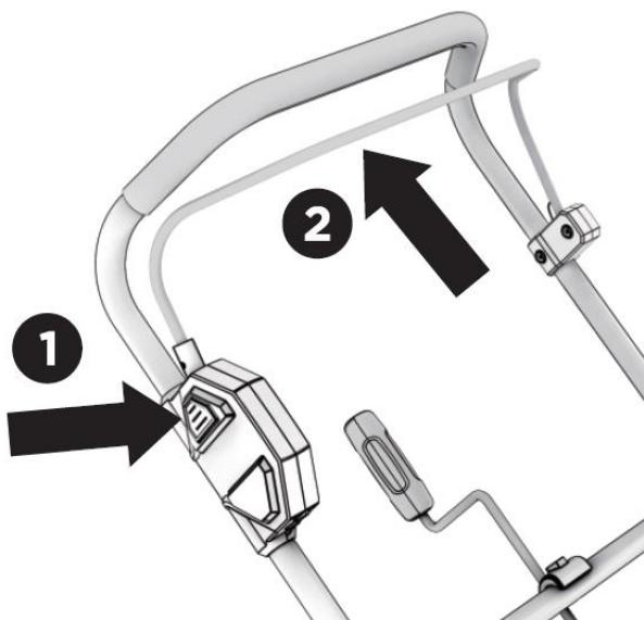
Het apparaat start nu. Als u de gashendel loslaat, werkt het apparaat niet meer.
