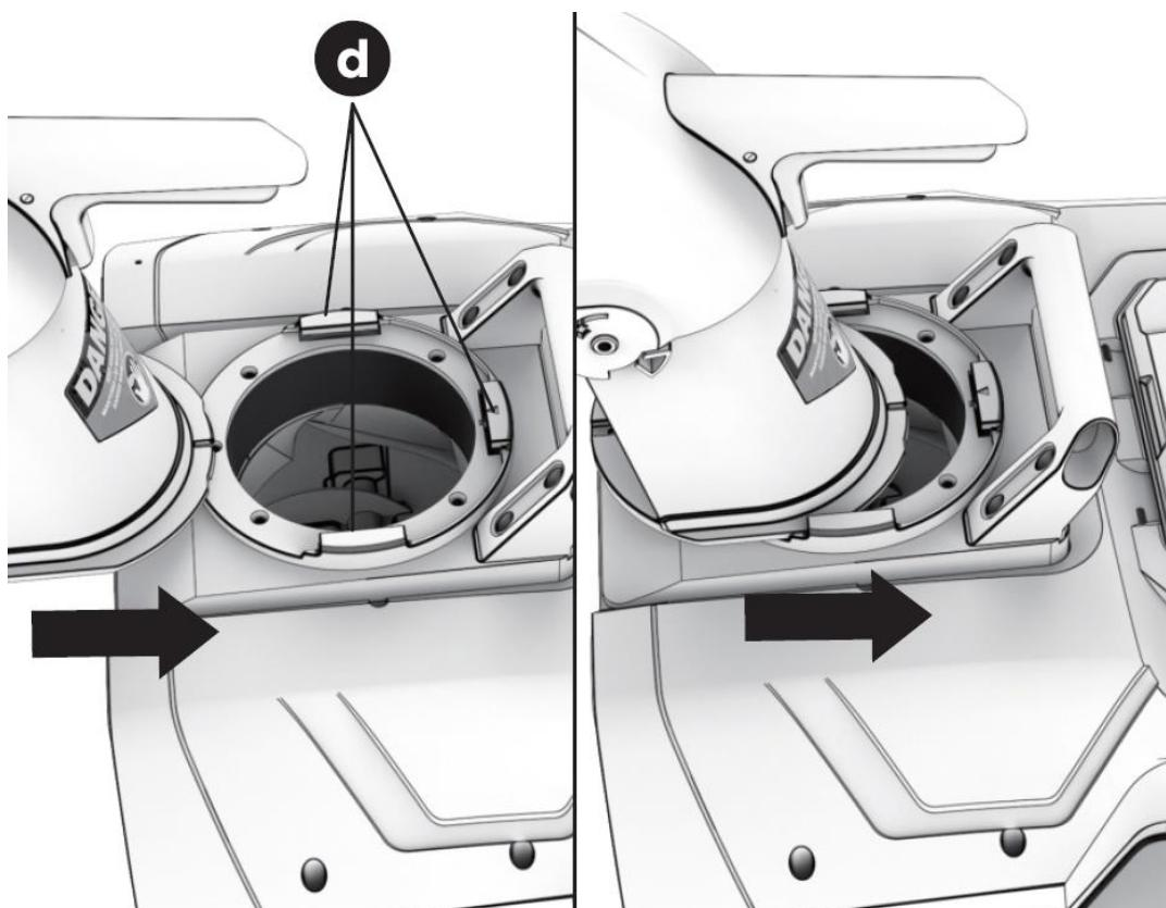
Użyj śrubokręta (brak w zestawie), aby zabezpieczyć rynnę wyrzutową za pomocą dołączonej śruby, jak pokazano poniżej.
