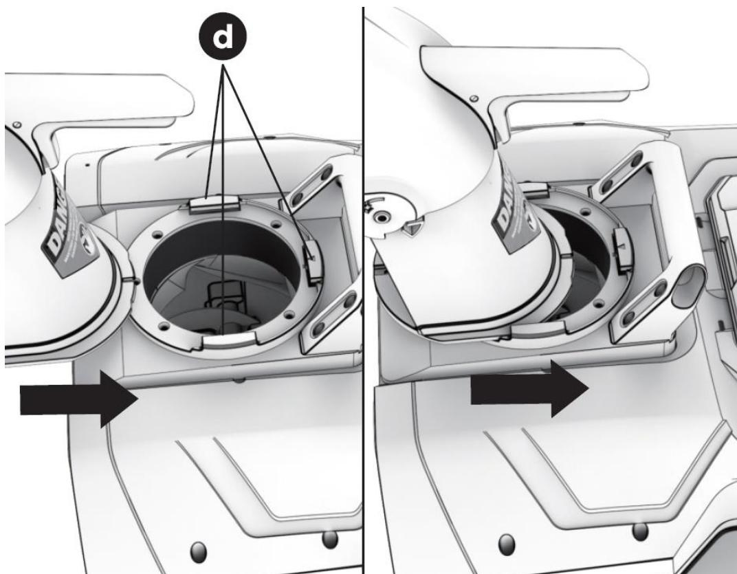
Use uma chave de fenda (não incluída) para fixar a calha ejetora com o parafuso incluído, conforme mostrado abaixo.
