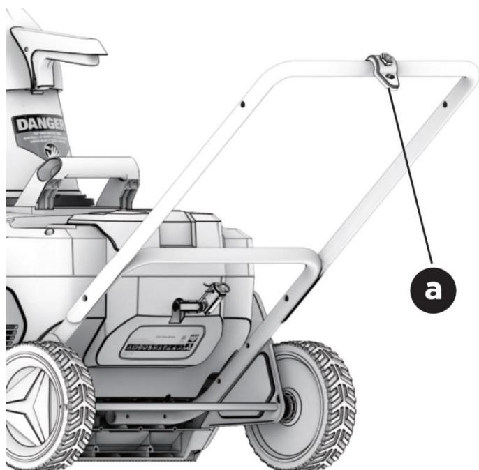
Inserire la leva di fissaggio del manubrio con rondella dall'esterno del manubrio centrale attraverso i fori allineati. Collegare il connettore all'estremità della leva di bloccaggio dall'interno della barra inferiore e ruotare la leva in senso orario per serrarla successivamente (vedere le illustrazioni seguenti).
