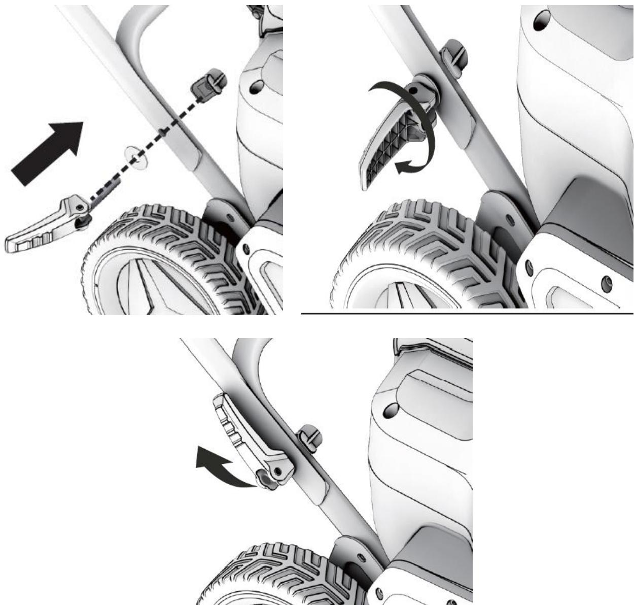
Vollziehen Sie bitte die gleichen Arbeitsschritte bei der Montage des oberen Holms am mittleren Holm (siehe folgende Abbildungen)
