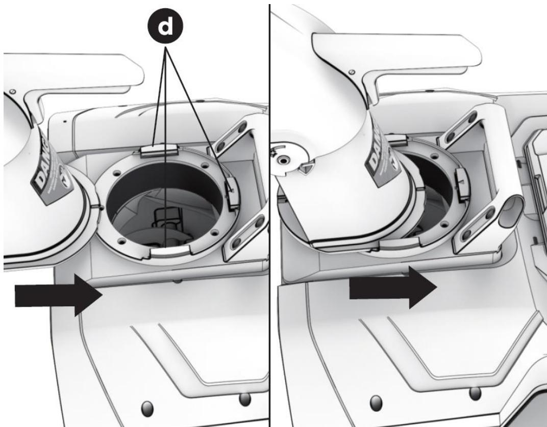
Använd en skruvmejsel (medföljer ej) för att fästa utkastrännan med den medföljande skruven som visas nedan.
