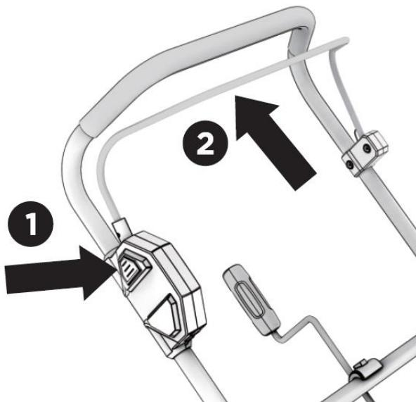
Urządzenie zostanie teraz uruchomione. Jeśli zwolnisz manetkę przepustnicy, urządzenie przestanie działać.
