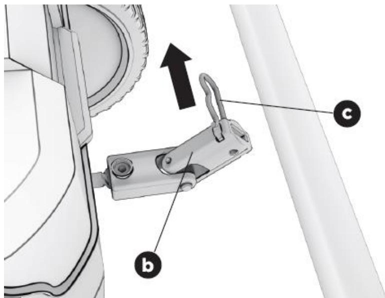
Deslize a alavanca giratória da calha através do suporte na alça central. Certifique-se de que a manivela da alavanca rotativa aponta para baixo. Em seguida, insira a alavanca na abertura na parte traseira da caixa. Prenda a alavanca rotativa com a cupilha (veja as ilustrações a seguir).
