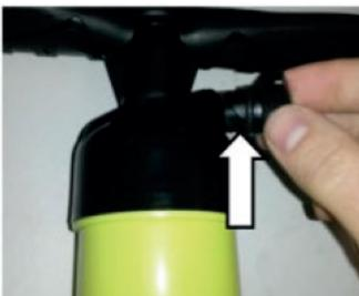
d. Beginnen Sie nun damit, die Luft in das Board zu pumpen, indem Sie die Pumpe auf und ab bewegen. Zu Beginn können Sie die volle Wirkung der Doppelhubkolbenpumpe ausnutzen und am Ventil der Pumpe auf den Doppel-Hub-Betrieb umstellen. Ist das SUP-Board soweit aufgepumpt, dass sich die Pumpe mittels Double-Action betrieb nicht mehr pumpen lässt, so stellen Sie das Ventil der Pumpe auf Einfach-Hub-Betrieb um. Pumpen Sie das SUP-Board nun bis 15PSI (1 Bar) auf.
