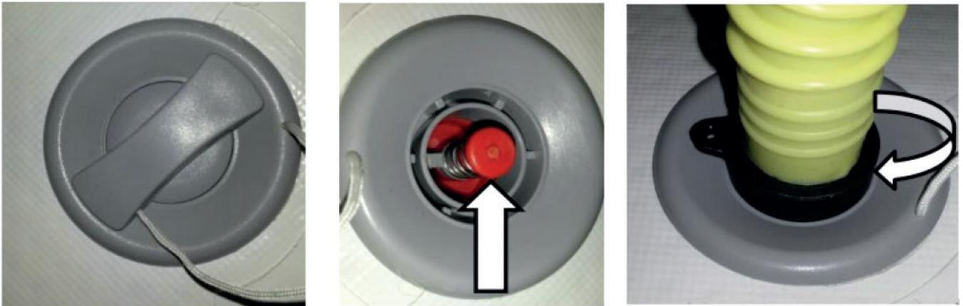
Um die Luft aus dem SUP Board abzulassen, drücken Sie den Ventilpin und drehen Sie diesen um ca. 45 Grad, sodass dieser in der unteren Position eingerastet bleibt. Um Beschädigungen am Ventil vorzubeugen, reinigen Sie dieses vor dem Ablassen und Aufpumpen des Boards.
