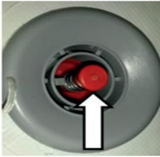
a. Drücken Sie auf den Ventilpin, damit durch einen natürlichen Unterdruck etwas Luft in das SUP-Board eindringen kann. Achten Sie danach darauf, dass das Ventil vor dem Aufpumpen mit der Pumpe geschlossen ist.
