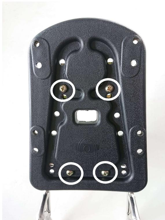
Anschließend muss der Top Case Träger (mit Grundplatte) mit dem Top Case verschraubt werden (lange Schrauben verwenden)
