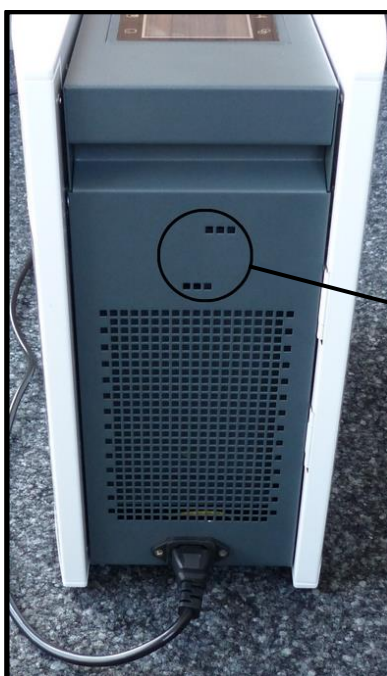
Luftschlitze des Luftsensorbereichs
