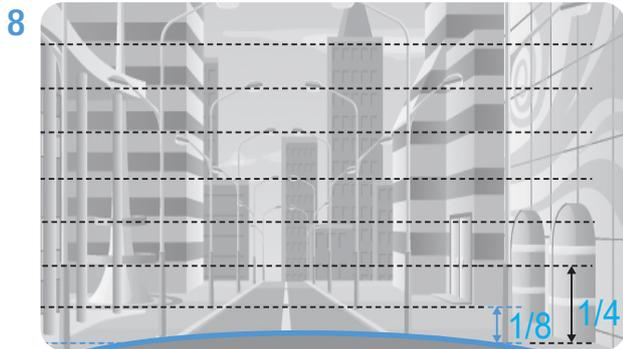
Verbinden Sie das Produkt mit der App **THINKWARE DASH CAM LINK** auf Ihrem Smartphone, und passen Sie den Kamerawinkel mithilfe des Liveansicht-Bildschirms so an, dass die Motorhaube des Fahrzeugs zwischen 1/8 und 1/4 des Bildschirms einnimmt (siehe Abbildung links).
