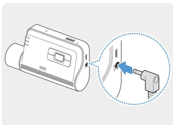
Schließen Sie das Dauerstromkabel an den Gleichstromanschluss des Produkts an und starten Sie den Motor, um zu prüfen, ob das Produkt normal funktioniert.
