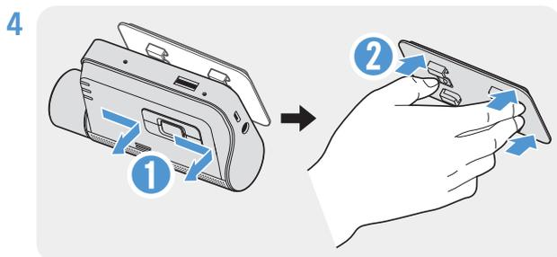
Nehmen Sie das Produkt aus der Halterung, und drücken Sie dann die Halterung an die Windschutzscheibe, um sie sicher zu befestigen.
