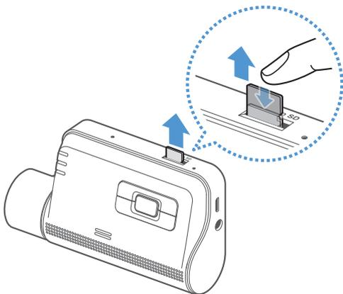
Stellen Sie vor dem Entnehmen der Speicherkarte sicher, dass das Gerät ausgeschaltet ist. Drücken Sie mit Ihrem Fingernagel sanft auf das untere Ende der Speicherkarte, damit sie sich löst, und entnehmen Sie sie dann aus dem Gerät.
