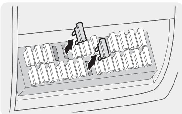
Öffnen Sie den Sicherungskasten, suchen Sie die Dauerstromklemme (die Strom liefert, wenn das Fahrzeug ausgeschaltet ist) und die ACC-Klemme (die Strom liefert, wenn die Zubehörstromversorgung des Fahrzeugs an ist) mit einem elektrischen Prüfgerät und trennen Sie die Sicherungen von den Klemmen.
