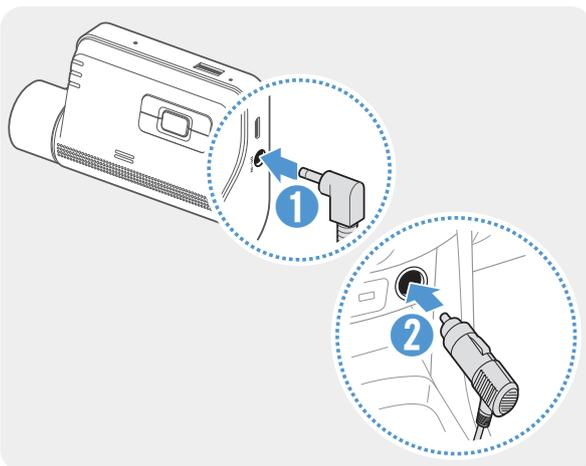
Verbinden Sie das Autoladegerät mit dem Gleichstromeingang des Produkts und den Zigarettenanzünder mit der Stromversorgung des Fahrzeugs.
