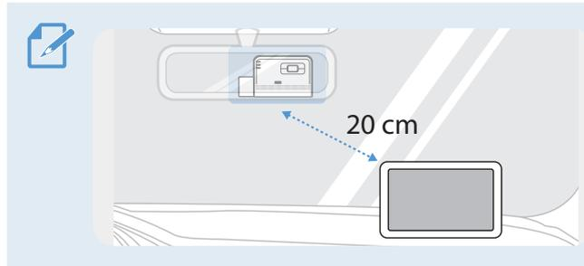
Der Empfang von GPS-Navigationsgeräten auf dem Armaturenbrett kann je nach Montageposition der Kamera beeinträchtigt werden. Verändern Sie die Position des GPS-Navigationsgeräts so, dass ein Abstand von mindestens 20 cm zwischen den beiden Geräten besteht.
