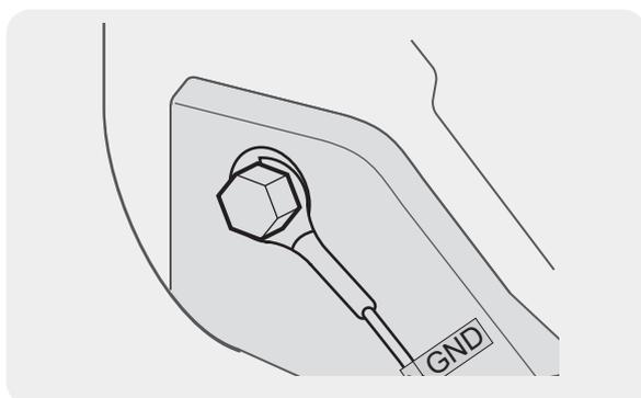
Schließen Sie den Erdungsdraht (GND) an eine Schraube an, die an einem metallischen Teil der Fahrzeugkarosserie befestigt ist.
