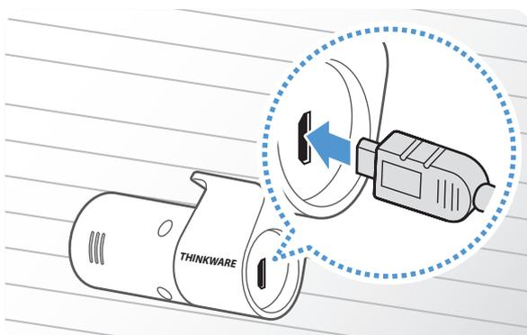
Schließen Sie das andere Ende des Kabels an den Verbindungsanschluss der Frontkamera an.
