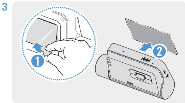
Entfernen Sie die Schutzfolie von der Klebhalterung, und drücken Sie diese an entsprechenden Stelle fest.
