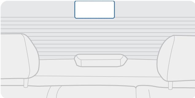
Wählen Sie eine Stelle auf der Heckscheibe, an der kein Heizungsdraht verläuft und von der aus die Kamera alles aufnimmt, was hinter dem Fahrzeug geschieht.
