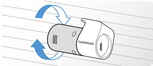
Passen Sie den vertikalen Winkel der Kamera an.
