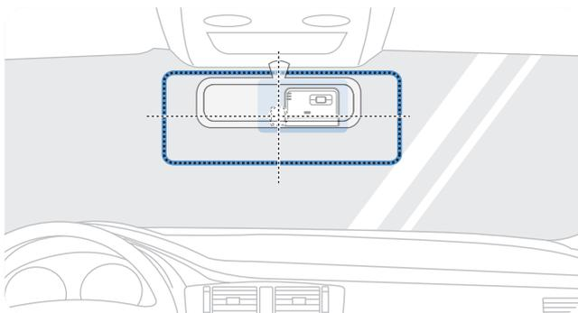
Wählen Sie eine Montageposition, von der die Kamera alles aufnimmt, was vor dem Auto geschieht, ohne das Blickfeld des Fahrers einzuschränken. Stellen Sie sicher, dass sich die Linse der Frontkamera in der Mitte der Windschutzscheibe befindet.
