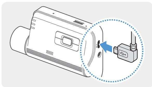
Schließen Sie ein Ende des Kabels der Heckkamera an den Spannungseingang der Frontkamera an.
