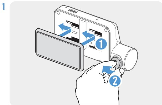
Richten Sie die Halterung an der Schiene am Gerät aus, und schieben Sie sie solange in die Schiene, bis Sie ein Klicken hören (1). Entfernen Sie dann vorsichtig die Schutzfolie (2).
