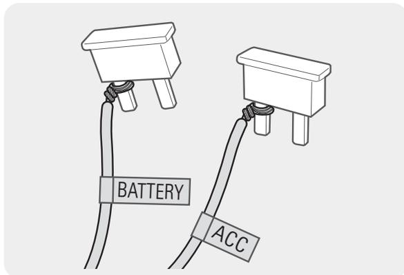
Schließen Sie den Batteriedraht an einen Sicherungskontakt der Dauerstromklemme und den ACC-Draht an einen Sicherungsweig der normalen Klemme (ACC) an.
