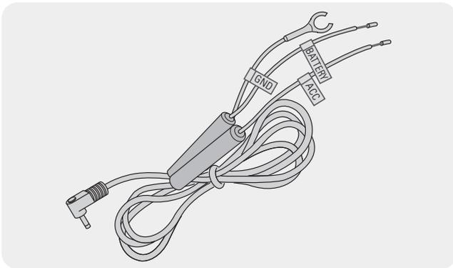
Wenn Sie das Produkt über das Dauerstromkabel mit dem Fahrzeug verbinden, arbeitet die Kamera auch dann weiter, wenn das Fahrzeug nicht in Betrieb ist (Parkmodus). Im Parkmodus erkennt die Kamera eventuelle Kollisionen mit dem Fahrzeug und Bewegungen in der Nähe und zeichnet Videomaterial auf.
