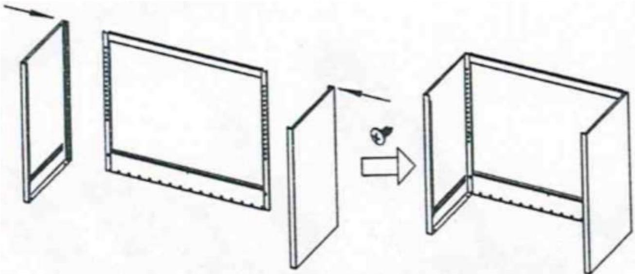
**SCHRITT 2** Montieren Sie den vorderen Rahmen (F)
