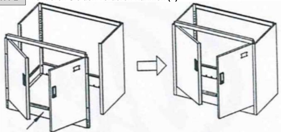
**SCHRITT 3** Montieren Sie die Bodenplatte (B)
