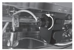
Nehmen Sie die verbrauchte Batterie heraus und ersetzen Sie sie durch eine frische.
